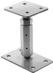
Höhenverstellbarer Balkenträger unter Terrassen und Holzdecks, zum Abtrag LOTRECHTER Lasten. in den Ausführungen „mit Zapfen“ und „mit Einlassplatte“ auch als Stützenfuß geeignet.
